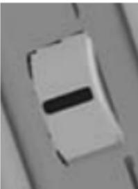
Contrariamente aos aparelhos de medição manual convencionais, este aparelho de medição não possui um teclado, mas sim a chamada “roda de polegar”, no lado esquerdo do aparelho. A roda pode ser girada 15° para baixo e para cima, e pode também ser pressionada para a posição central.
