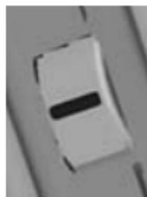
В отличии от обычных ручных измерительных приборов данный измерительный прибор имеет не клавишную панель, а так называемое «цевочное колесо» на левой стороне прибора.
