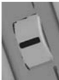
A diferencia de otros instrumentos de medición manuales, este aparato no posee un teclado, sino una denominada “rueda pulgar” en el lado izquierdo. Esta rueda permite girarse 15° hacia arriba y abajo, y, además, permite pulsarse en su posición central.
