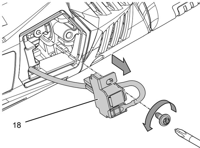
4. Comprima un poco las bridas de sujeción (19) y deslice la escobilla de carbono sin usar (21) en la guía del soporte de escobillas de carbono (18) hasta que las bridas de sujeción (19) se encajen en esta.
