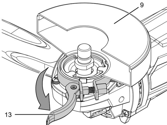
2. Gire la cubierta de protección (9) hacia la posición de trabajo. Preste atención a que el lado abierto de la cubierta de protección quede hacia la pieza de trabajo. El lado cerrado de la cubierta de protección tiene que quedar siempre hacia el usuario.
