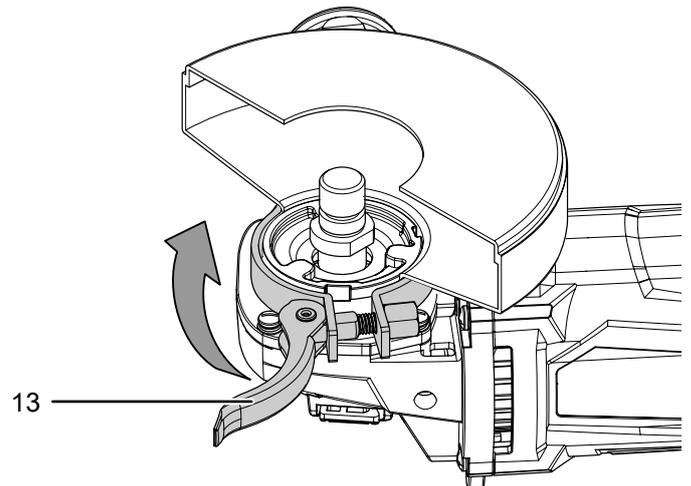
4. Compruebe que la cubierta de protección (9) esté correctamente bloqueada. La cubierta de protección no puede dejarse mover. Usted puede aumentar la fuerza tensora del cierre apretando el tornillo de ajuste (11).
