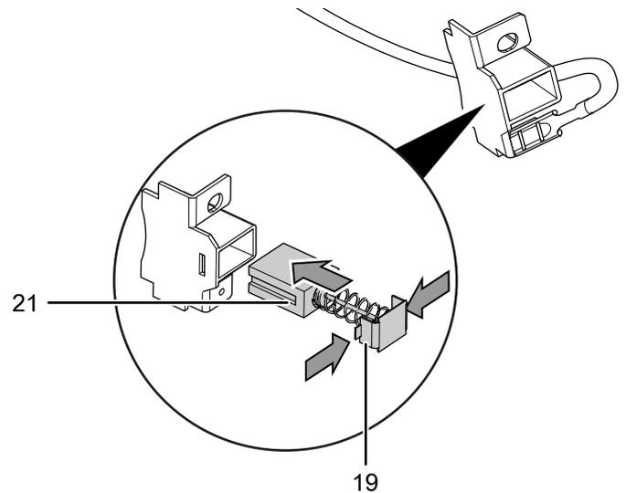
3. Presione las bridas de sujeción (19) en el soporte de las escobillas de carbono con una herramienta adecuada (18) y extraiga de la guía la escobilla de carbono usada (20).
