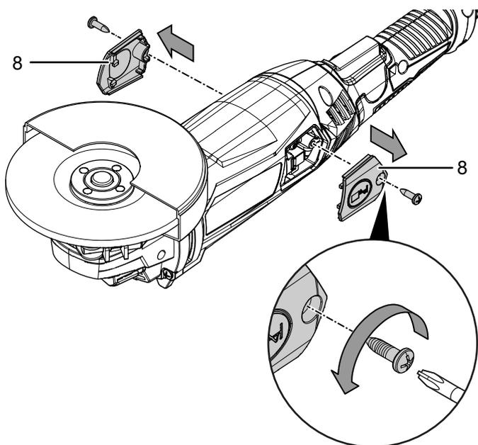
2. Afloje el tornillo del soporte de las escobillas de carbono (18) y tire de él un poco hacia adelante.
