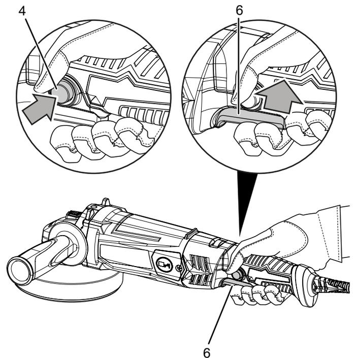
5. Realice una marcha de prueba, sin carga, después de cada cambio de muela y antes de cada puesta en marcha durante aprox. 1 minuto para comprobar si la muela de tronzar ha sido colocada correctamente.
