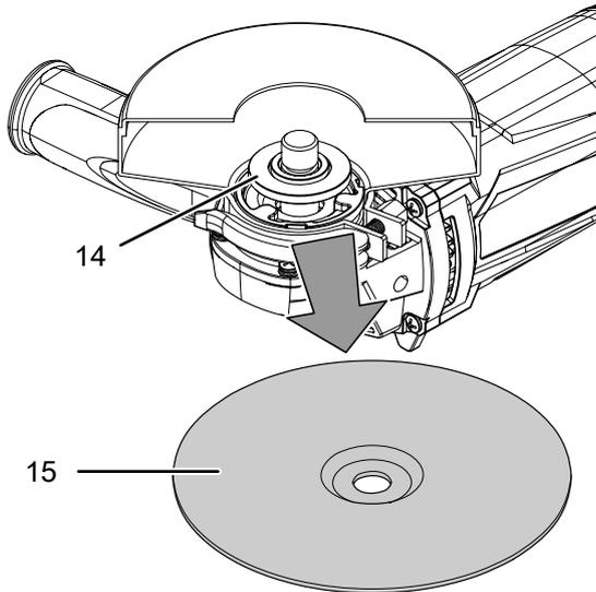
5. Coloque la muela de tronzar (15) sobre la brida de apoyo (14). El rótulo debe quedar hacia el aparato. Preste atención a que el agujero de la muela de tronzar encaje sin holgura en la brida de apoyo. No use ninguna pieza reductora o adaptador.
