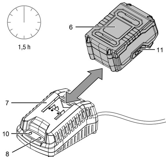
2. Inserte la clavija de alimentación del cargador rápido (7) en una toma de corriente debidamente protegida.
