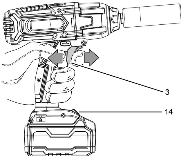
4. Para apagar el aparato vuelva a soltar el interruptor de encendido y apagado (3).
