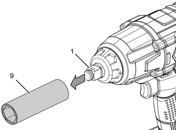
3. Deslice la llave de vaso correspondiente (9) sobre el portaherramientas (1) hasta que oiga que encaja.
