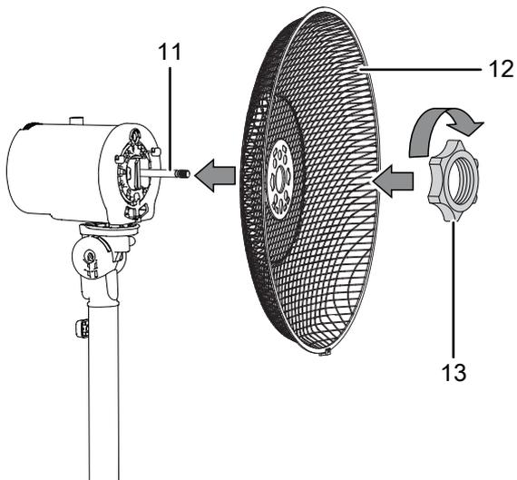
**Fijar las aspas al eje del motor**
