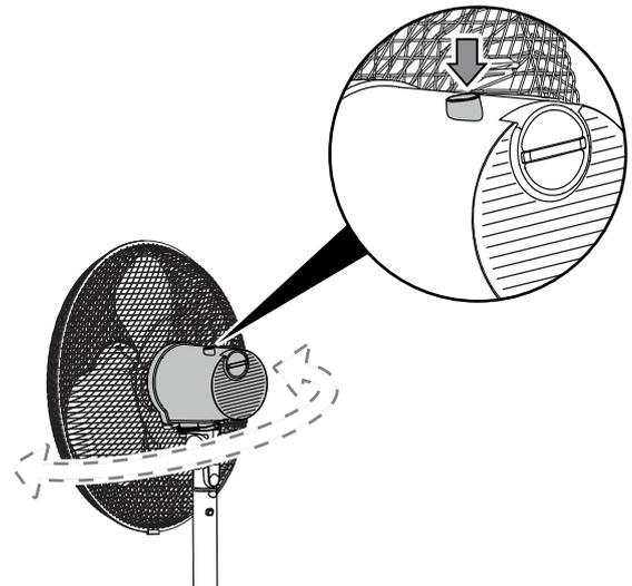
1. Tire nuevamente de la espiga de oscilación (7) para volver a desconectar la oscilación.
