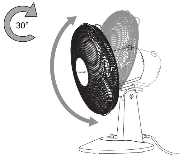
⇒ El ángulo de inclinación del ventilador está ajustado y la corriente de aire se concentra en el ángulo de inclinación escogido.
