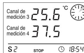
Una vez transcurrido este intervalo de 5 segundos, la visualización cambia automáticamente y en la pantalla se muestran los valores de medición de los canales de medición 3 y 4.
