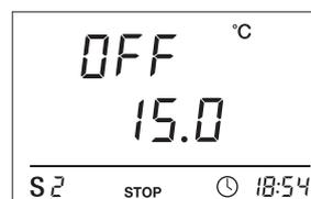
Si no se ha conectado ningún sensor a la conexión externa 1 (canal de medición 3) para este canal de medición, en lugar del valor de medición aparecerá la siguiente indicación en la pantalla: OFF.
