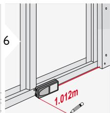
Mover el dispositivo lentamente a lo largo de la línea de replanteo. Se visualiza la distancia hasta el siguiente punto de replanteo.
