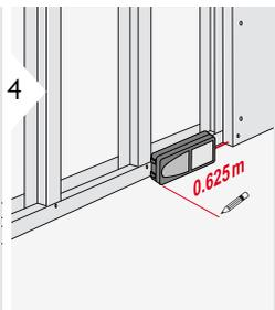
Mover al aparato lentamente a lo largo de la línea a medir. Se visualiza la distancia hasta el siguiente punto de medición.
