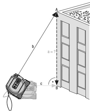
1. Pulse la tecla (11) repetidamente hasta que en la pantalla aparezca el símbolo para la medición indirecta.
