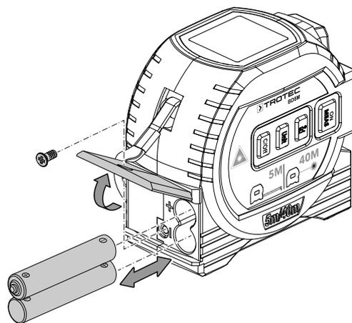
3. Vuelva a colocar la tapa del compartimento sobre el aparato y atorníllela.
