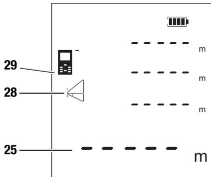
3. A continuación, dirija el aparato hacia el punto más alto (C) y pulse brevemente la tecla de encendido / medición (7) para llevar a cabo la medición. Para ello, intente mantener el aparato lo más firmemente posible. **La orientación del aparato respecto al punto de referencia no se debe modificar durante las mediciones!**
