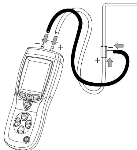
3. Pulse la tecla *P/V/F* (14) hasta que en el indicador *Modo de medición* (36) aparezca *FLOW*.
