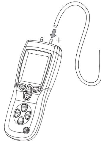
2. Pulse la tecla *P/V/F* (14) hasta que en el indicador *Modo de medición* (36) aparezca *PRESS*.
