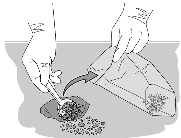
3. Triture el material de la muestra para que todo el material de comprobación presente un grano inferior a 8 mm.
