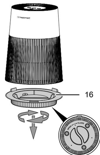
2. Extraiga del aparato el filtro de carbón HEPA (17) usado.
