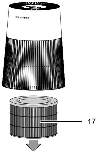
3. Elimine el filtro de carbón HEPA usado conforme a la normativa nacional correspondiente.
