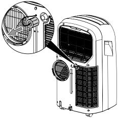
3. Conecte la manguera de salida de agua condensada a la conexión para manguera (5).
