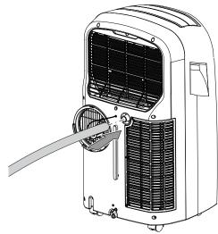
4. Conecte el otro extremo de la manguera a un desagüe apropiado (por ejemplo un sumidero o un recipiente colector suficientemente grande). La manguera de salida de agua condensada no puede doblarse y su trayecto hacia el sumidero no puede ser en pendiente, ya que en ese caso el agua condensada no puede salir.
