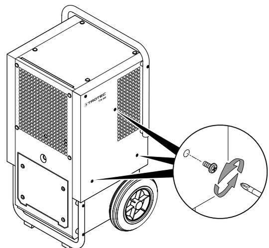
2. Afloje y retire los tornillos por el lado frontal del aparato.
