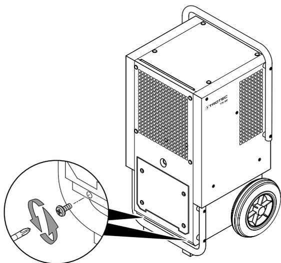
3. Afloje y retire los tornillos por el lado trasero del aparato.
