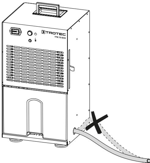
Cuando desee volver a recoger el agua condensada en el depósito quite la manguera. Deje secar la manguera antes de guardarla.
