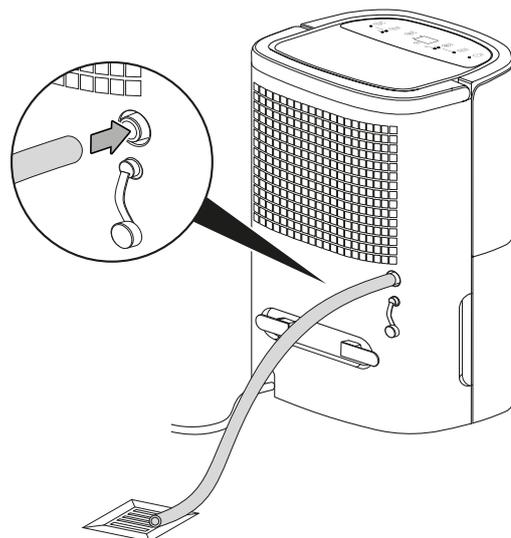
3. Conecte el otro extremo de la manguera a un desagüe apropiado (por ejemplo un sumidero o un recipiente colector suficientemente grande). Asegúrese de que la manguera no se pueda doblar.
