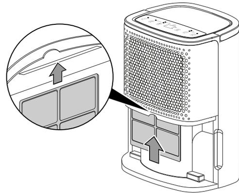
6. Vuelva a colocar el depósito de agua condensada en el aparato.
