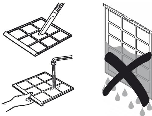
4. Deje que el filtro se seque completamente. No coloque nunca el filtro en el aparato mientras esté húmedo.
