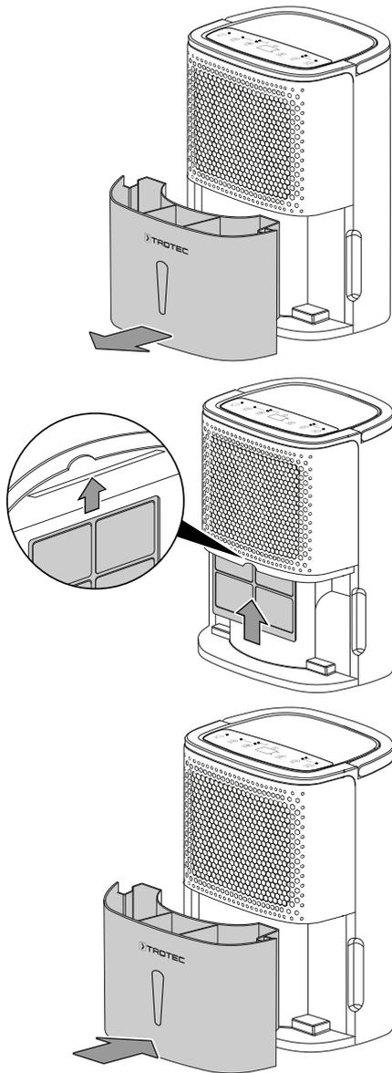
**Colocar el depósito de agua condensada**
