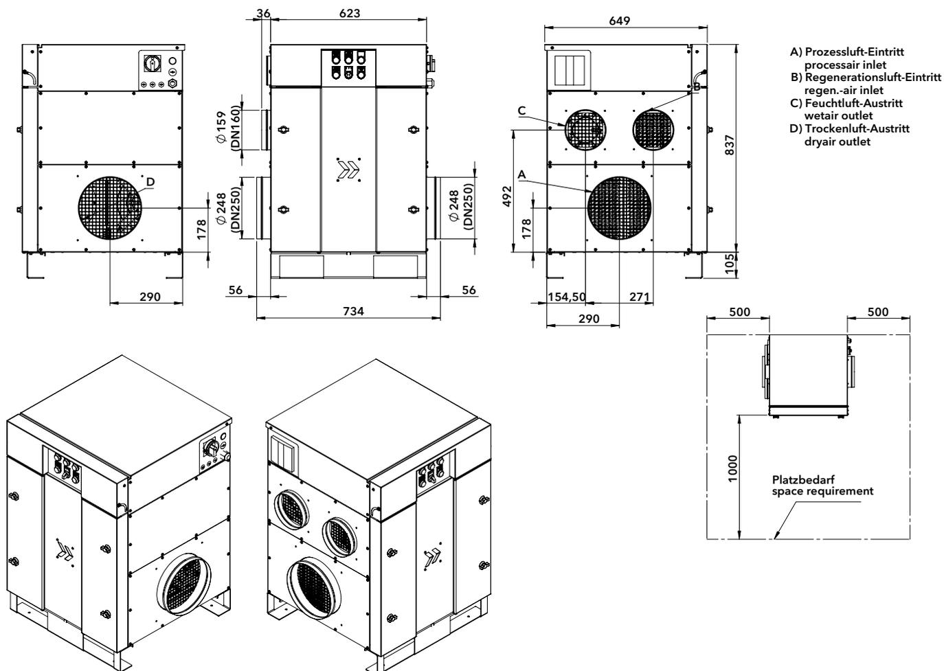
Sujeto a cambios. Todos los datos de rendimiento se refieren a 1013 mbar, una densidad de 1,2 kg / m³ y una fuente de alimentación con 3x400 V / 50Hz + PE o 230V / 50 Hz. Para el diseño de su proyecto, recomendamos un descuento de seguridad según la aplicación en términos de rendimiento de deshumidificación del 10-20%.
