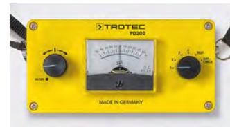
conduce rápidamente a la zona de fuga y, mientras nos acercamos a la ubicación exacta de la misma, este valor puede incrementarse en varios niveles.
