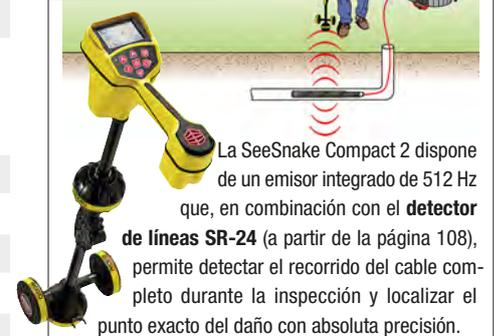
La SeeSnake Compact 2 dispone de un emisor integrado de 512 Hz que, en combinación con el **detector de líneas SR-24** (a partir de la página 108), permite detectar el recorrido del cable completo durante la inspección y localizar el punto exacto del daño con absoluta precisión.
