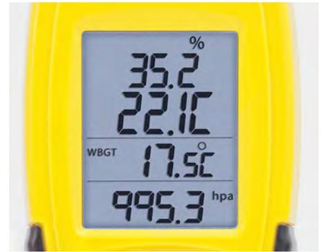
La LCD del TC100, con iluminación de fondo, muestra simultáneamente cuatro magnitudes de medición que pueden ser leídas incluso en entornos poco iluminados.
