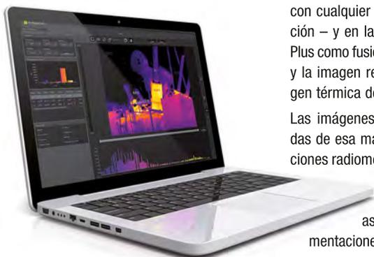
Con «IR-Report NG» puede, por ejemplo, configurar isotermas, activar histogramas estadísticos de temperatura, realizar mediciones puntuales, lineales y rectangulares en el termograma y crear y exportar informes.
