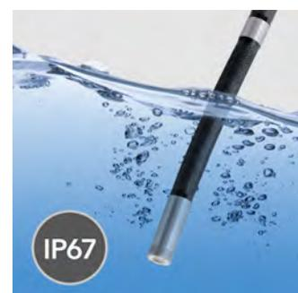
Con 1 m de longitud (ø 6 mm), la sonda IP67 resistente al aceite del VSC106 ofrece la máxima amplitud de movimiento a la vez que mantiene una alta resistencia a la torsión gracias a su estructura multicapa de malla de alambre de tungsteno y poliuretano sobre espiral de acero flexible.
