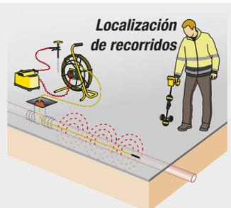
En el cabezal de la guía de los aparatos LTS se coloca una sonda muy fácil de localizar debido al campo especialmente fuerte. El transmisor se conecta por medio de dos cables a la caja de conexión del LTS.
