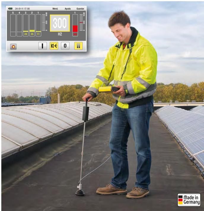
**Para una localización de fugas de exactitud puntual y pruebas de estanqueidad de cintas de impermeabilización, conductores y recipientes.**
