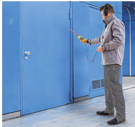
Combinadas con el emisor ultrasónico SL800T, las pruebas de estanqueidad de puertas cortafuegos pueden realizarse de manera rápida y económica.
