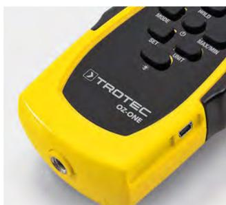
El OZ-ONE está dotado de una rosca para trípode y dispone de una conexión para mini-USB y una toma para conector coaxial de 9 V. A través de esos puertos también es posible, como alternativa al uso de baterías, el funcionamiento permanente conectado a la red eléctrica.
