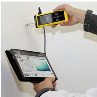
La función **LiveLog** de MultiMeasure Studio permite un registro automático de los datos de medición de aparatos compatibles durante la medición. Eso es práctico, por ejemplo, para la medición matricial in situ con la tableta Windows o el ordenador portátil.
