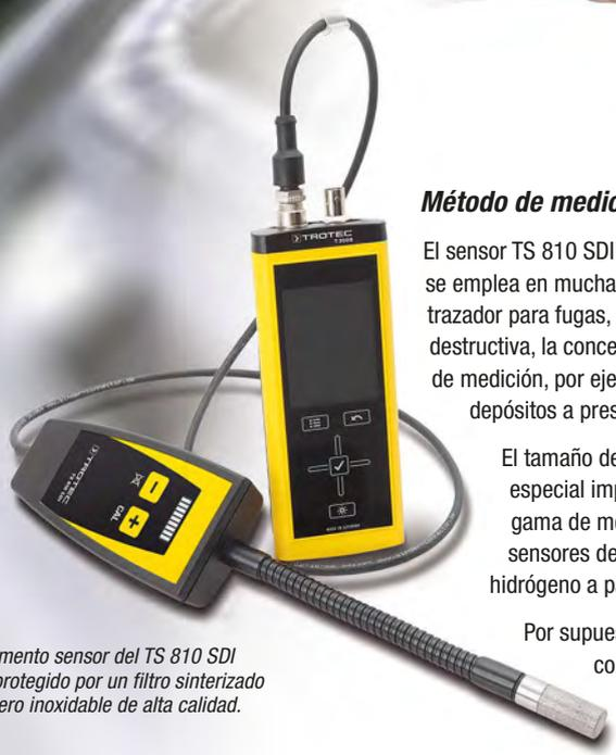
El elemento sensor del TS 810 SDI está protegido por un filtro sinterizado de acero inoxidable de alta calidad.
