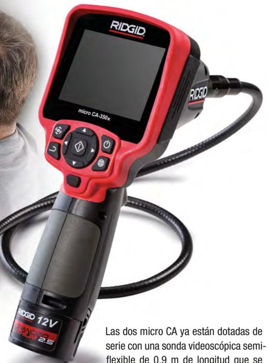
Las dos micro CA ya están dotadas de serie con una sonda videoscópica semi-flexible de 0,9 m de longitud que se puede extender opcionalmente hasta una longitud de 9 metros o que puede ser sustituida por una sonda con un cabezal de cámara extremadamente estrecho de 6 mm.
