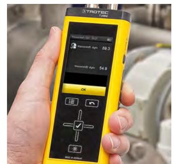
De esta forma, para saber la concentración más alta de H<sub>2</sub>, el usuario puede orientarse por el intervalo de la señal o por el valor indicado en la pantalla y así acotar sistemáticamente la localización de la fuga.
