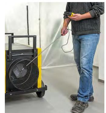
La sonda telescópica del TA300 se puede extender hasta una longitud útil de 1 m, lo cual garantiza una mayor comodidad en las mediciones. Práctico también para la medición de corriente en lugares alejados y de difícil acceso o en el interior de canales de aire y cajas de registro.
