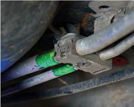
Fugas en la línea de refrigerante del aire acondicionado de vehículos mediante un agente de contraste bajo luz ultravioleta.
