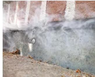
Prueba de un sellado deficiente de conexiones a pared por encima de un garaje subterráneo.
