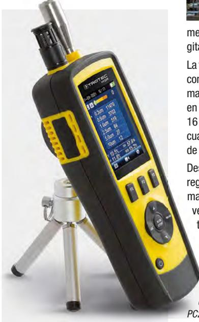
Una representación adicional mediante escala de colores con señal acústica de alarma automática facilita la rápida detección de concentraciones críticas de partículas.
