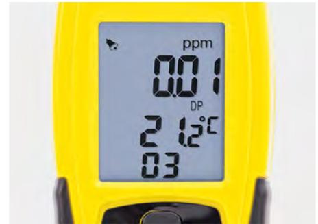
La LCD del OZ-ONE, con iluminación de fondo, muestra simultáneamente dos magnitudes de medición que pueden ser leídas incluso en entornos poco iluminados.
