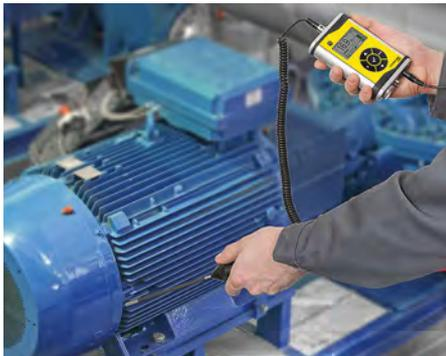
La sonda de sonido propagado por estructuras sólidas con punta de acero inoxidable resulta ideal para pruebas no destructivas como los controles de desgaste de rodamientos en piezas de máquina giratorias.
