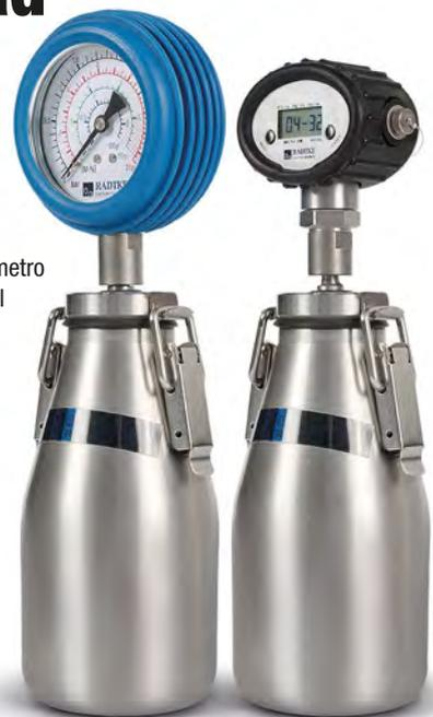
Si, por ejemplo, se ha realizado una medición a 35 °C constantes y se obtiene una presión de 0,8 bar, la humedad en CM% para un pesado de 50 g es de 1,57 CM % según la tabla o la escala.
