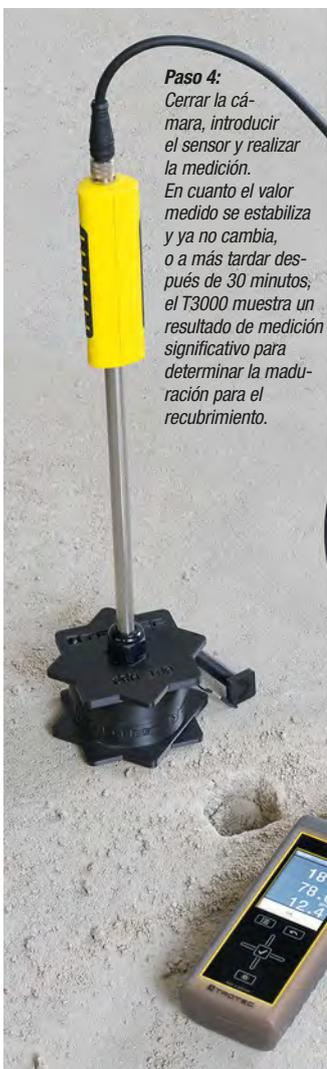
**Paso 4:** Cerrar la cámara, introducir el sensor y realizar la medición. En cuanto el valor medido se estabiliza y ya no cambia, o a más tardar después de 30 minutos, el T3000 muestra un resultado de medición significativo para determinar la maduración para el recubrimiento.
