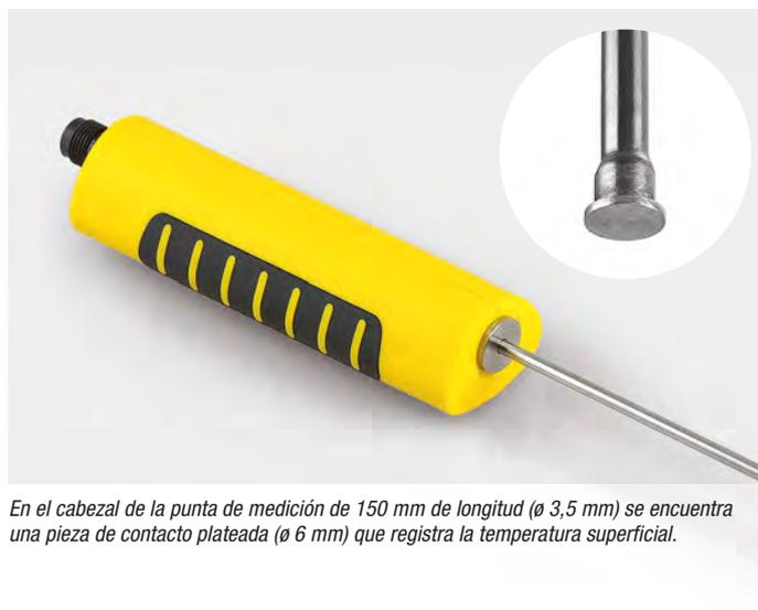
En el cabezal de la punta de medición de 150 mm de longitud (ø 3,5 mm) se encuentra una pieza de contacto plateada (ø 6 mm) que registra la temperatura superficial.
