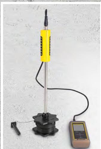
La cámara de medición CRH100 es ideal para su uso con el medidor multifuncional T3000 y el sensor climático TS 230 SDI conectado.
