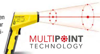
El puntero láser de punto múltiple del TP7 y el TP10 aúna ambas tecnologías para determinar el objeto de medición con facilidad y precisión a partes iguales: mientras el puntero láser central muestra el punto de medición, otros ocho láseres permiten visualizar los puntos del contorno del área de medición, lo cual permite realizar mediciones precisas en muy poco tiempo.
