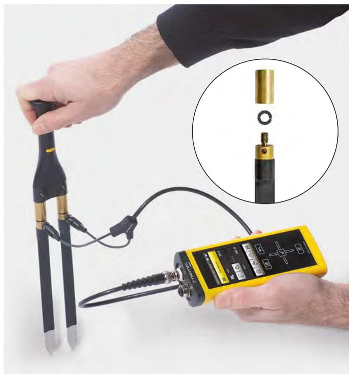
Con el juego de adaptadores TS 60 (19) se pueden conectar todos los electrodos MultiMeasure directamente al electrodo de mano del TS 60 (9). Además, los adaptadores cuentan por ambos lados con una rosca y se aseguran fácilmente mediante un anillo de apriete entre el cabezal de los electrodos y la punta de inserción del electrodo de mano.
