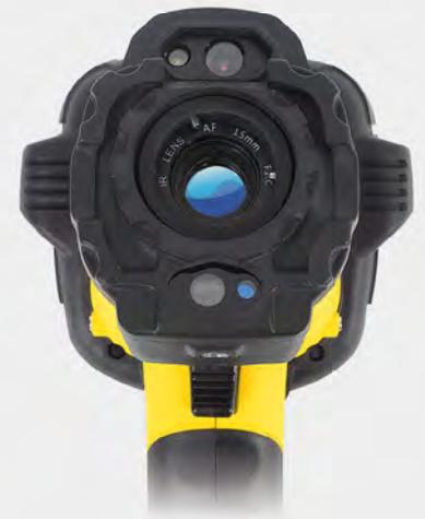
Las robustas cámaras XC están fabricadas con tipo de protección IP54 y estructura de dos componentes con protección frente a golpes, y en su parte frontal están equipadas además de con un objetivo estándar (24° x 18°), con una cámara de imágenes reales, lámpara fotográfica, un puntero láser y un láser adicional para la medición distancias.
