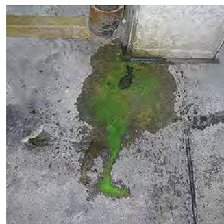
*Uranin Green ya es visible a simple vista en el punto de fuga y, mediante la excitación por fluorescencia con luz UV, también se puede realizar una rápida detección de trazas en grandes superficies.*
