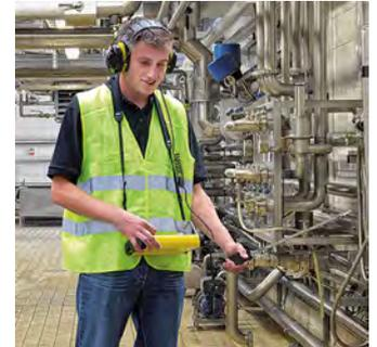
sensor de suelo con bomba de aspiración integrada para la detección de las más ínfimas concentraciones de gas trazador.
