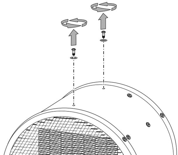
2. Monte el asa de transporte mediante los dos tornillos y las arandelas.
