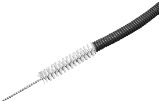
Fig. 6.3.4.5: Limpieza de las mangueras de la bomba
