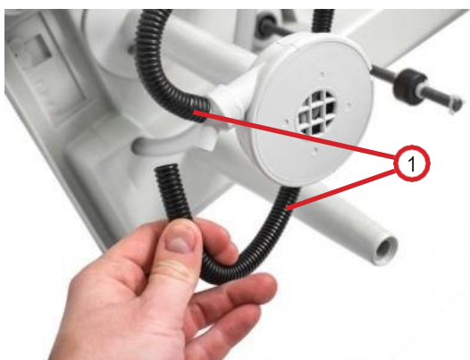
Fig. 6.3.4.4: Extracción de las mangueras de la bomba
