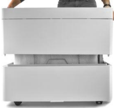
Fig. 7.4.1.1: Desmontaje de la parte superior de la carcasa
